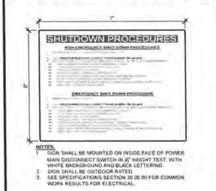
SHUT-DOWN SIGNAGE SCALE: N.T.S. 9
